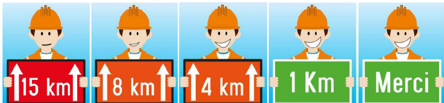
IL. Indication de longueur de chantier
